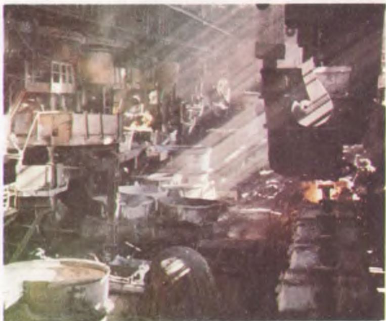
Общий вид мартеновского цеха при разливке стали в изложницы
