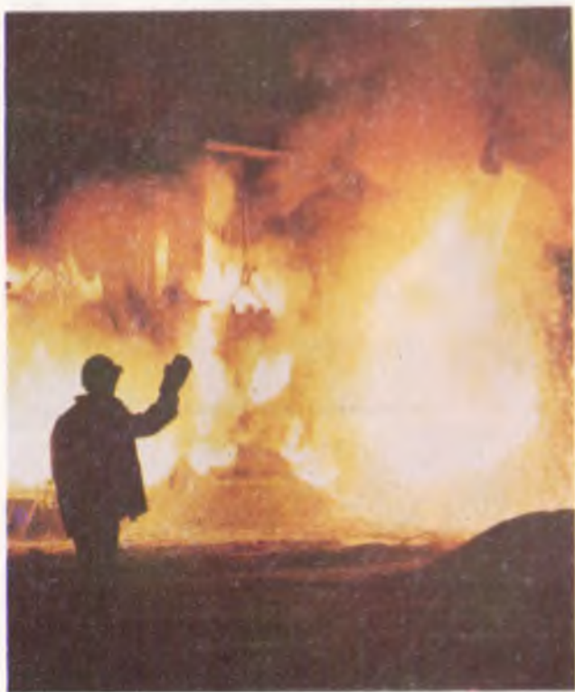
Заливка чугуна в мартеновскую печь из 100-тонного ковша
